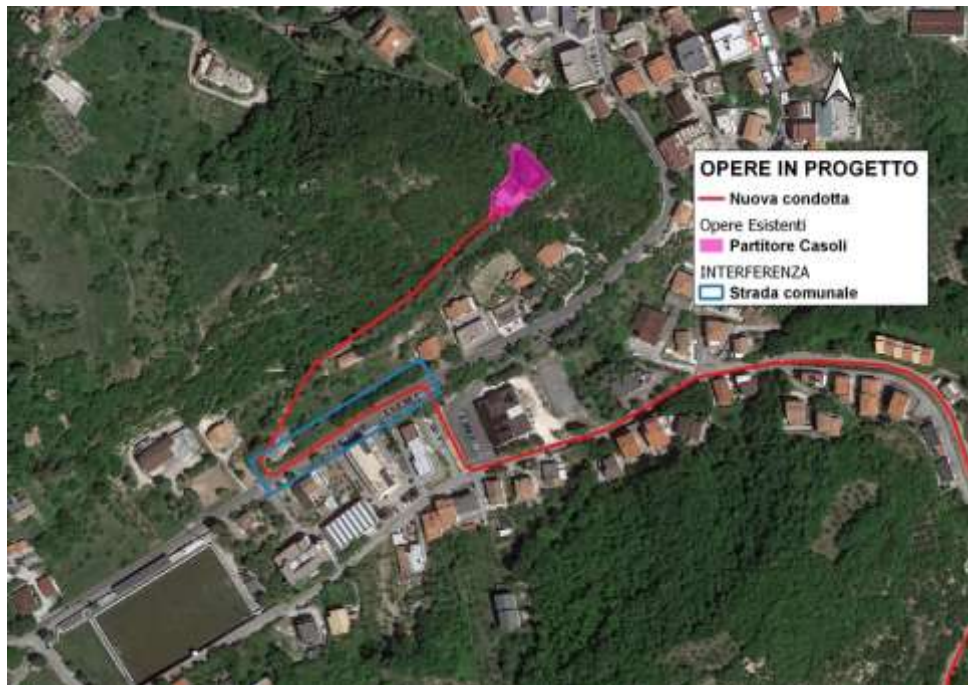
2-20 – Attraversamento longitudinale della condotta in progetto con la strada comunale esistente su Ortofoto.
