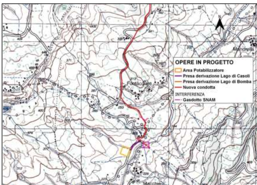
2-1 –Ubicazione del gasdotto SNAM (nel rettangolo in magenta) interferente con la presa derivazione lago di Bomba su cartografia IGM.
