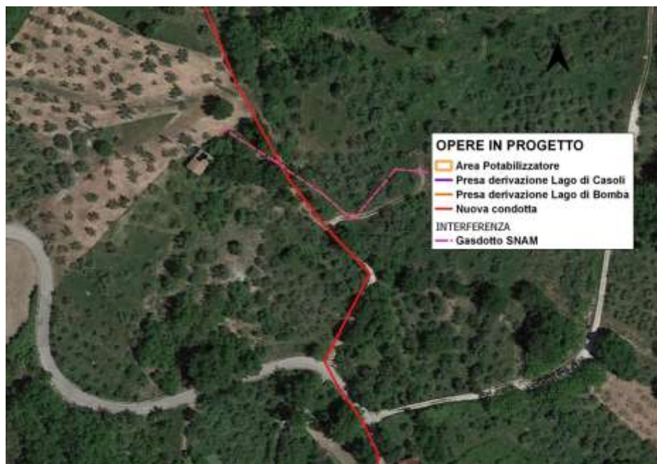
2-4 –Ubicazione del gasdotto SNAM interferente con la condotta in progetto su Ortofoto.
