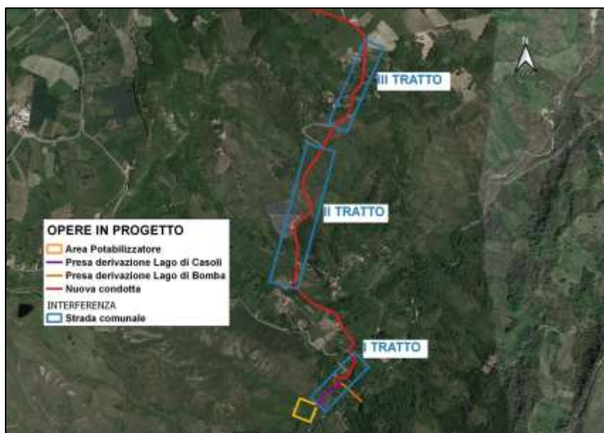
2-14 – Attraversamento longitudinale della condotta in progetto con la strada comunale esistente su Ortofoto.
