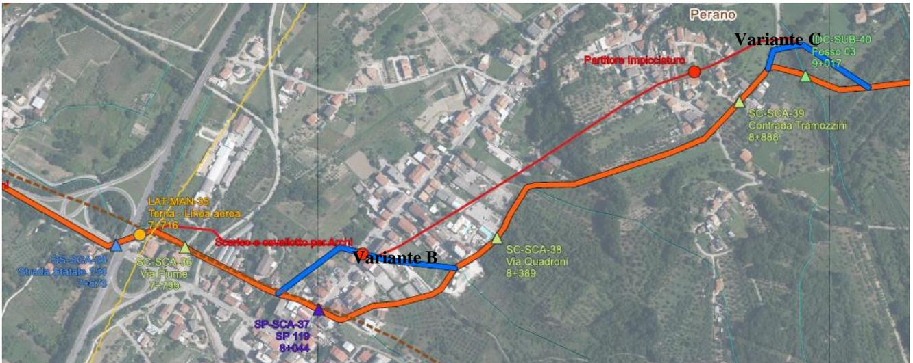
Figura 12: Soluzione di progetto (in arancione) e tratti in variante (in blu) - tratto da km 7+739 a km 9+127
