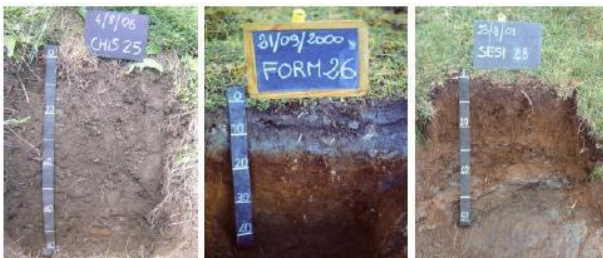
Figura 5-2: Esempi di scavi per rilevazione del profilo pedologico - (fonte "Capacità d'uso dei suoli a scala aziendale Allegato A" IPLA - Regione Piemonte)
