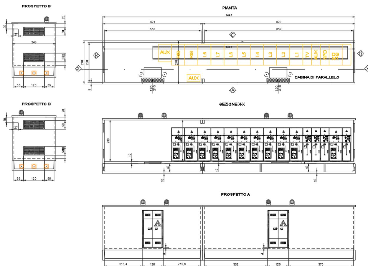
All'interno della cabina di parallelo sono presenti esclusivamente le apparecchiature di protezione e manovra di media tensione a 30kV integrate dei dispositivi ausiliari di telecontrollo e monitoraggio.
