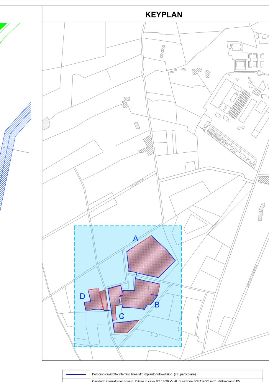
Cavidotto interrato per posa n. 2 linee in cavo MT 18/30 kV Al, di sezione 3(2x1x400) mm², dall'impianto PV. Lunghezza di circa 8,9 km.
