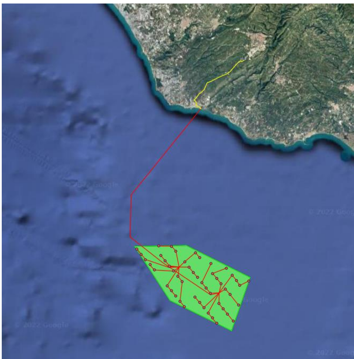
Figura 2 – Localizzazione del parco eolico, con posa in mare e a terra, da stazione offshore a RTN Ragusa (RG)
