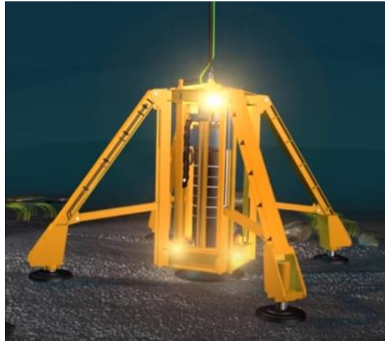
Figura 2-7 – Esempio di palo infisso nel fondale marino
