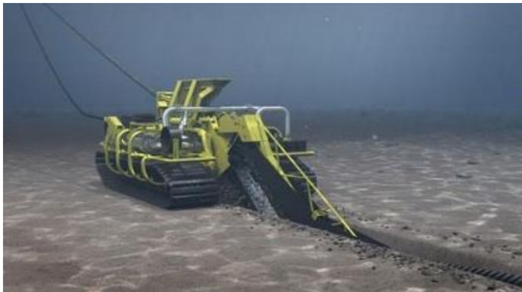
Figura 2-15 – Sistemi protezione dei cavi per interramento
