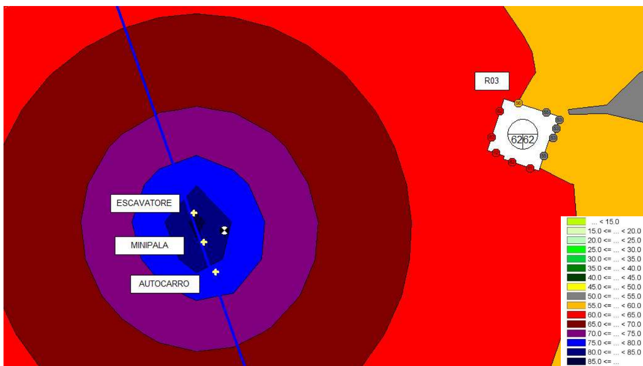
Figura 6 – Stralcio planimetrico della mappa acustica calcolata in corrispondenza del recettore residenziale R03 nelle fasi di cantiere maggiormente critiche (Fase 16 e Fase 18).
