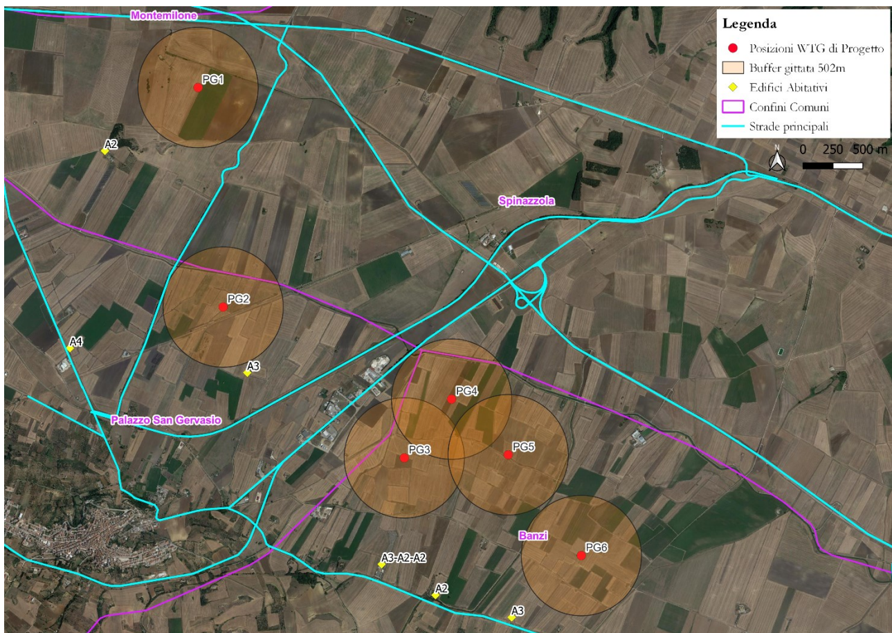
Figura 3: Ubicazione degli aerogeneratori del gruppo PG1 – PG6 rispetto alle strade principali ed edifici abitativi esistenti.
