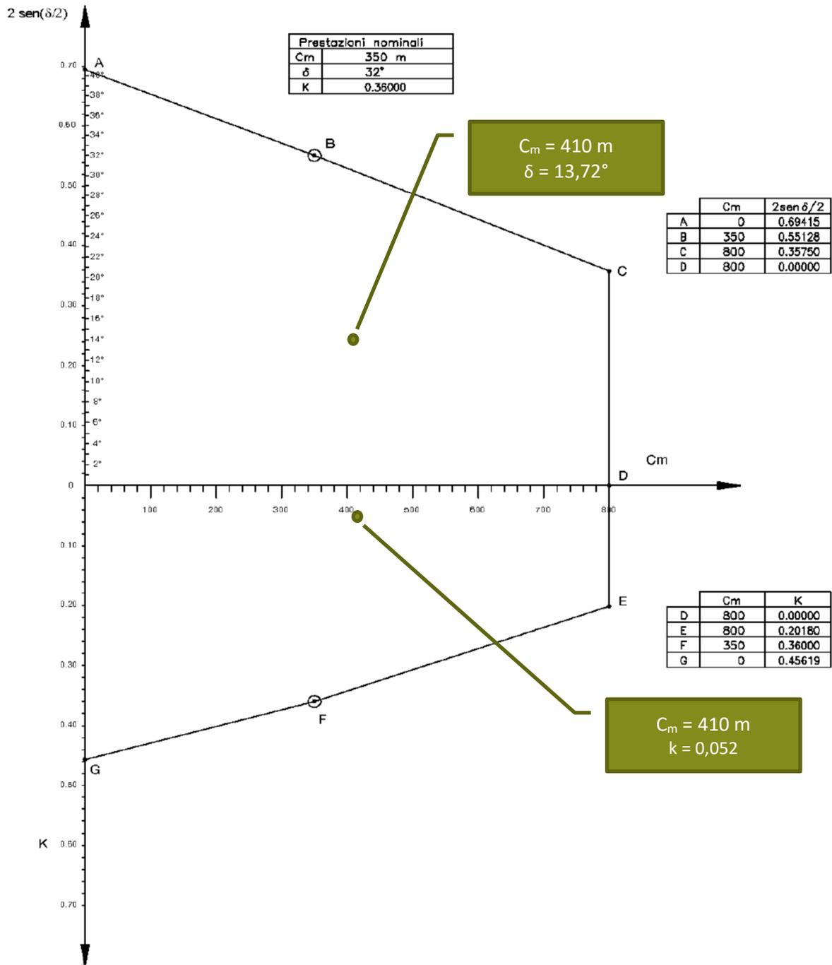
Figura 3: Diagramma di utilizzazione "Sostegno V" Sospensione – SOSTEGNO 31VAR
