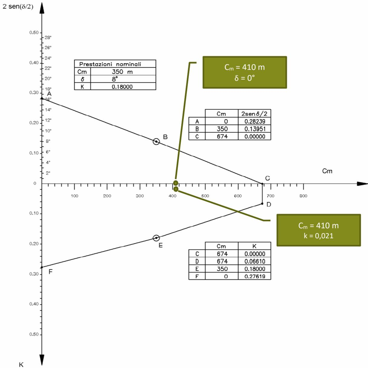
Figura 2: Diagramma di utilizzazione "Sostegno M" Sospensione – SOSTEGNO 30VAR
