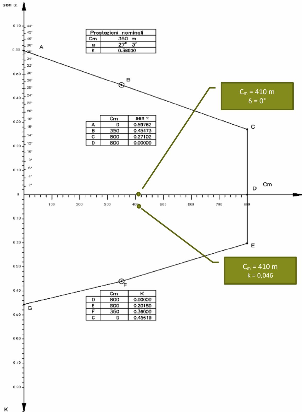
Figura 5: Diagramma di utilizzazione "Sostegno E" Amarro/Capocorda – SOSTEGNO 33VAR
