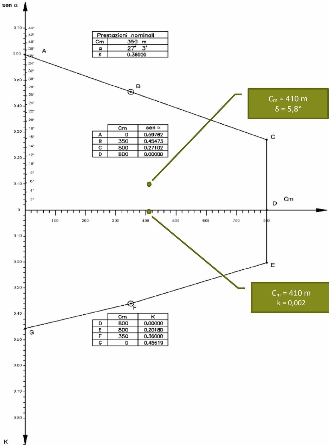
Figura 4: Diagramma di utilizzazione "Sostegno M" Amarro/Capocorda – SOSTEGNO 32VAR
