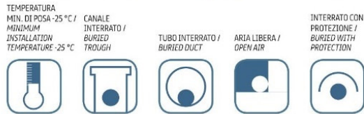
Figura 13: Caratteristiche del cavo ARP1H5E 30 kV 1/2
