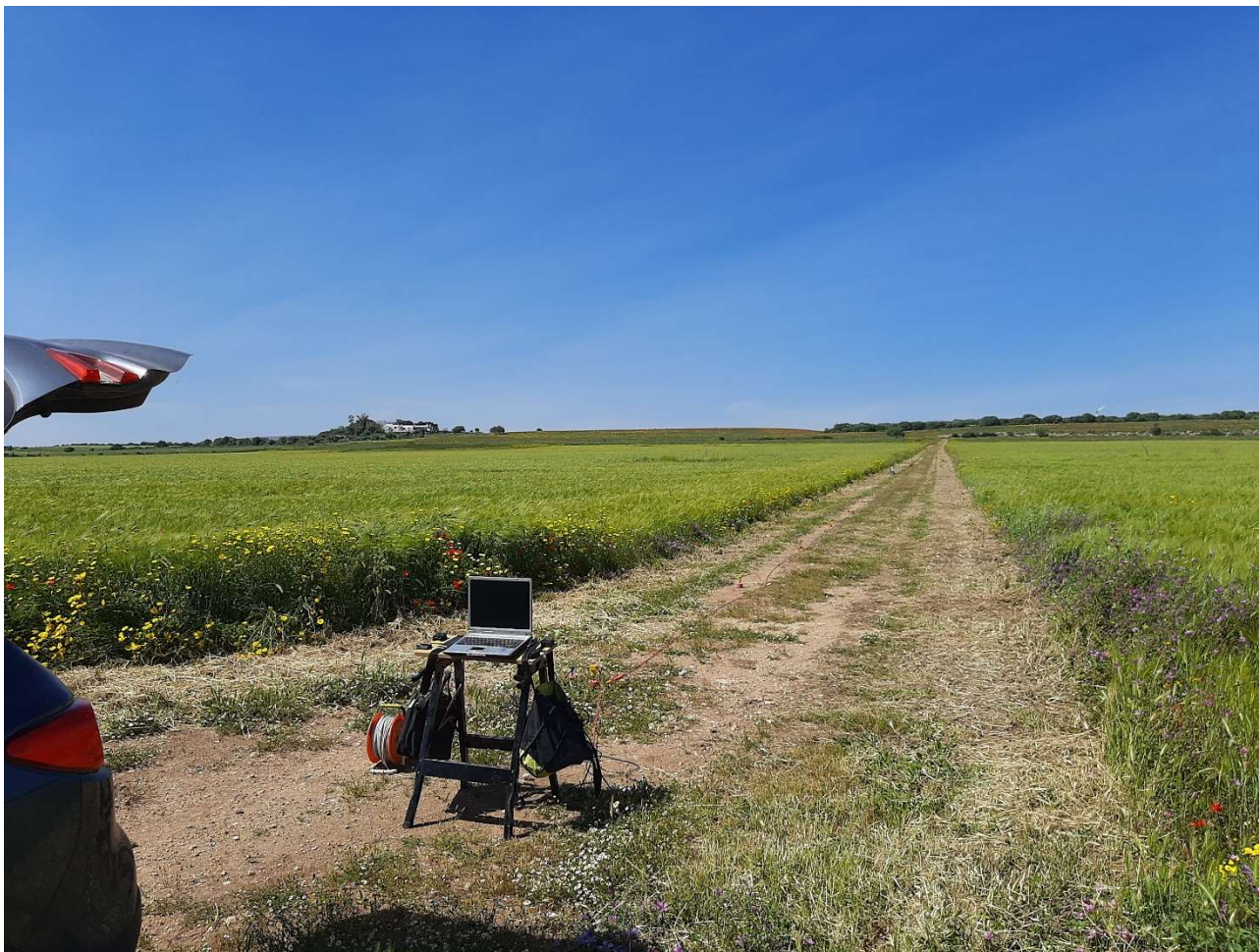
Figura 38 – Fase indagini geognostiche stesa sismica effettuata in sito: fase di acquisizione del rilievo sismico
