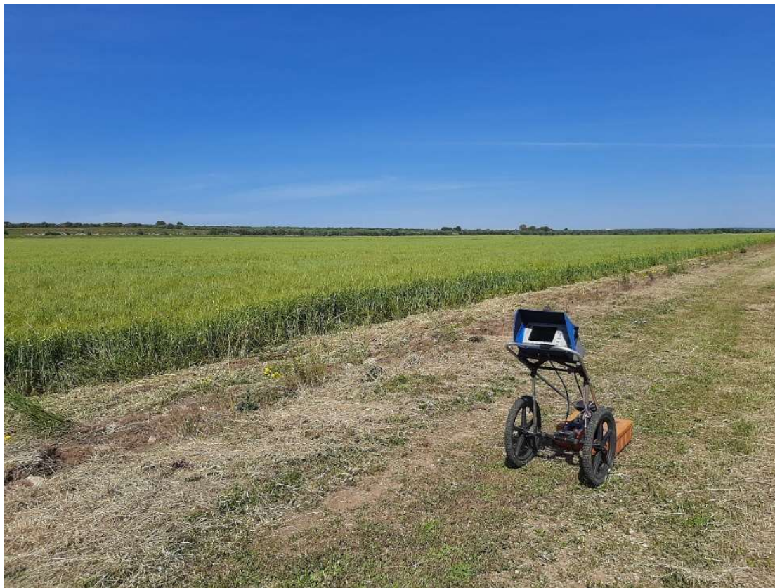
Figura 8 - Fase indagini geognostiche effettuate in sito
