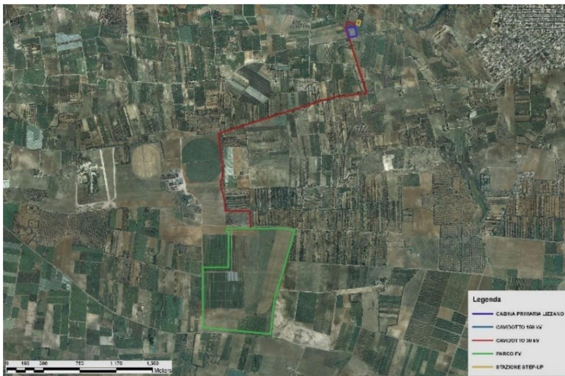
Figura 1 – In verde, limiti dell'area destinata alla messa in opera dell'impianto fotovoltaico; in rosso, tracciato del caviodotto di collegamento alla cabina elettrica di Lizzano.
