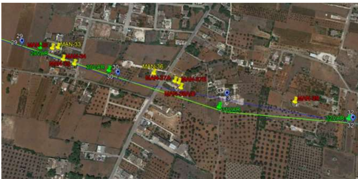
Figura 6.7 – Variante su ortofoto dal sostegno 29 al 32VAR
