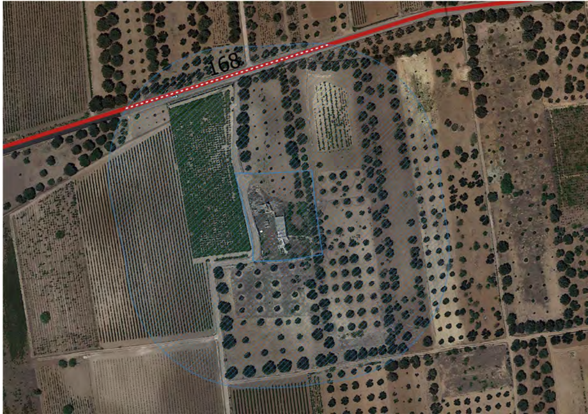
Figura 1.16 – Attraversamento della linea del cavidotto interrato dell'area di rispetto della Masseria La Fica dallo Stralcio della cartografia del P.P.T.R. (Fonte: www.sit.puglia.it )
