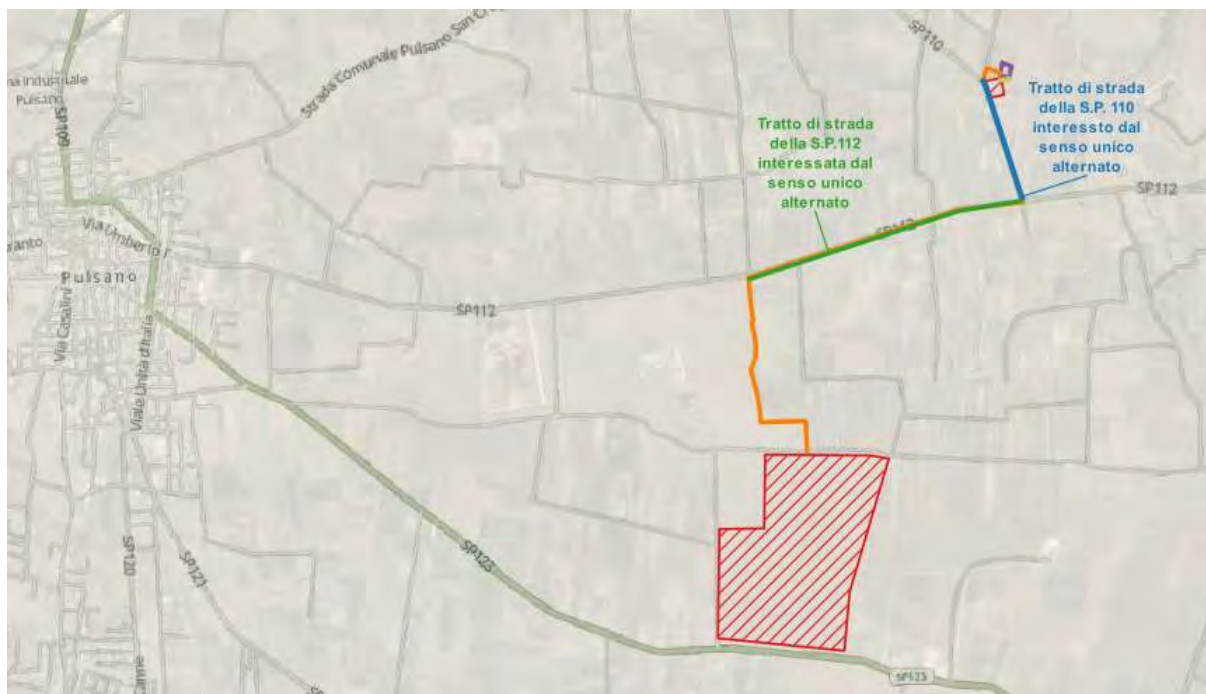
Figura 3.42 – Viabilità interessata dal cavidotto di connessione: in verde il tracciato del cavidotto MT che interessa la S.P. 112, in blu il tracciato del cavidotto MT che interessa la S.P. 110
