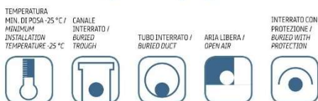
Figura 5.17: Caratteristiche del cavo ARP1H5E 30 kV 1/2
