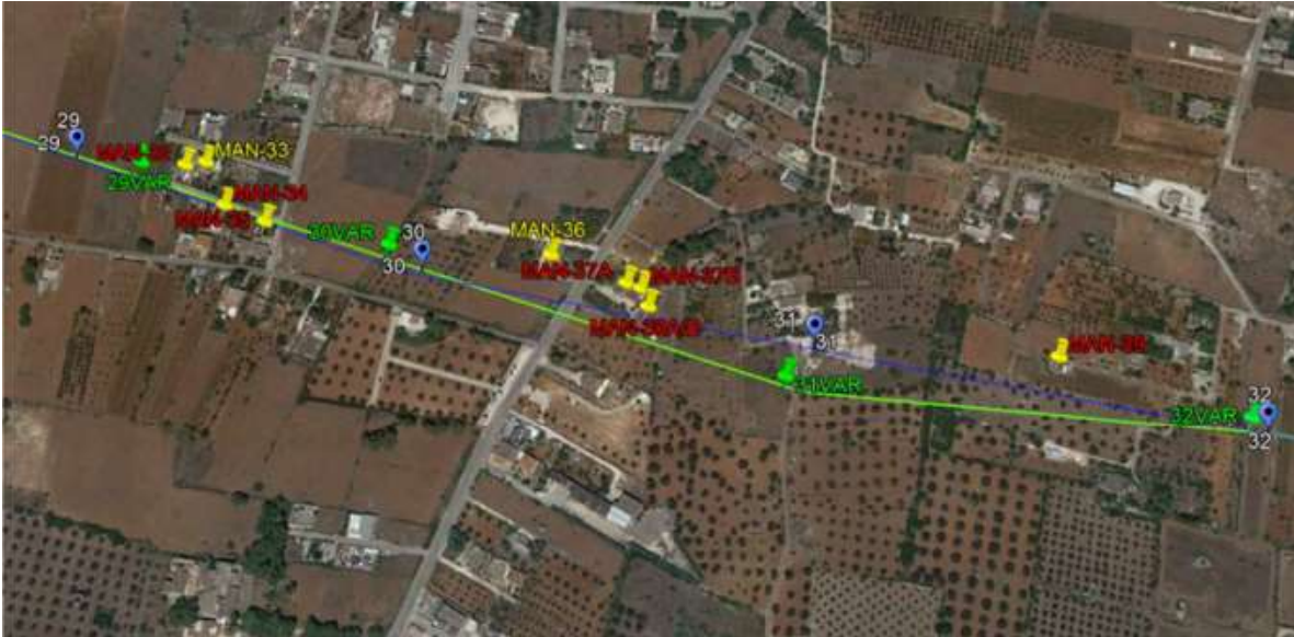
Figura 5.34 – Variante su ortofoto dal sostegno 29 al 32VAR
