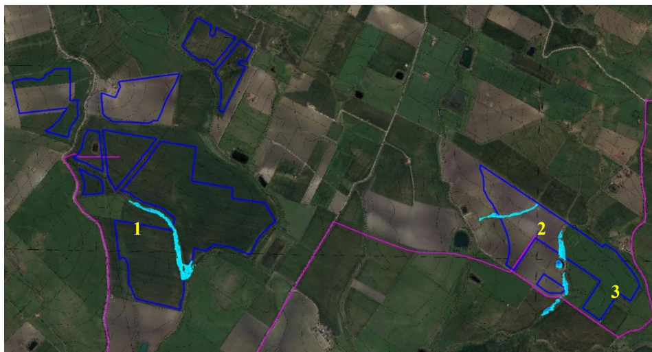
Figura 5 – impluvi individuati con le relative altezze del tirante idraulico con TR100
