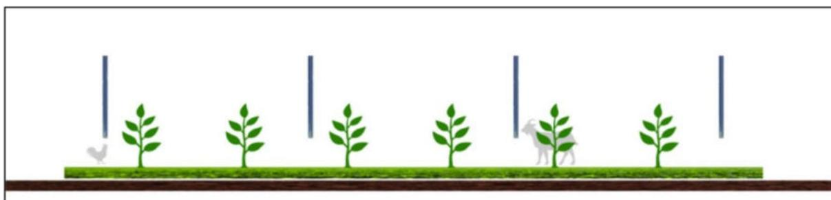
Figura 56 - Sistema agrivoltaico in cui i moduli fotovoltaici sono disposti verticalmente. La coltivazione avviene tra le file dei moduli fotovoltaici, l'altezza dei moduli da terra influenza il possibile passaggio di animali (TIPO3)
