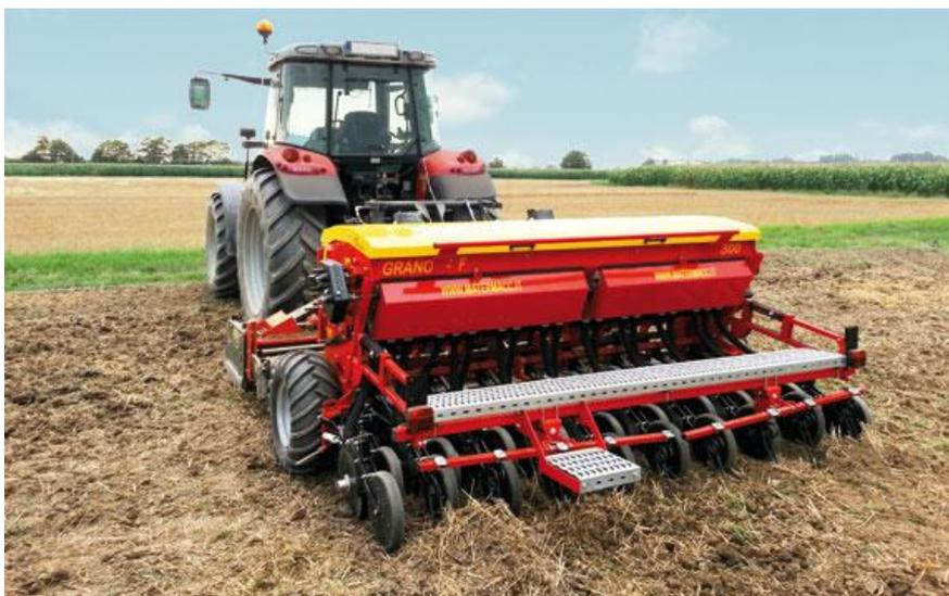
Figura 209 - Esempio di seminatrice di precisione per tutte le tipologie di sementi
