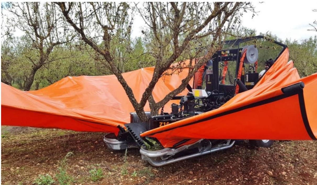
*Figura 211 - Macchina frontale per la raccolta delle olive/mandorle su impianto intensivo*
