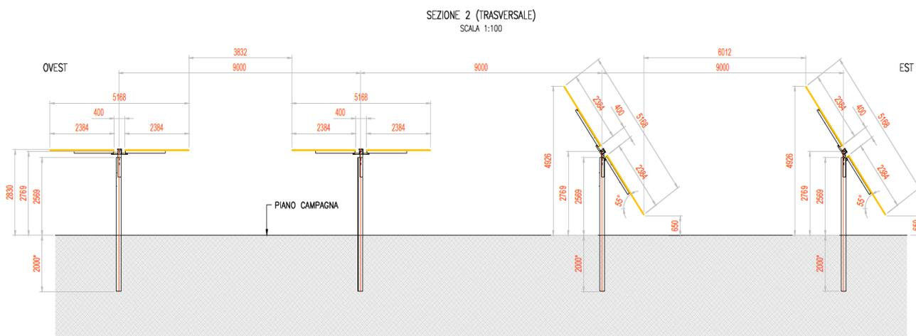
**Particolare strutture sostegno moduli pannelli e distanze di campo (interfila m 9)**
