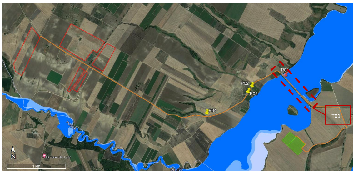
Figura 5.2: Stralcio piano assetto Idrologico (PAI) del bacino Fortore. Il percorso del cavo di connessione interferisce con fasce di pericolosità alta, media e bassa.
