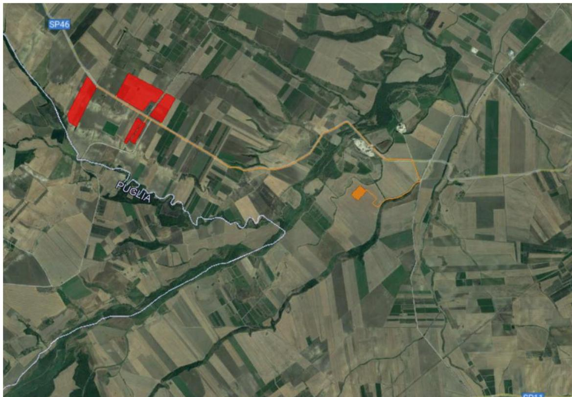
Figura 2.11: in rosso l'area recintata del campo FV, in arancio la linea di connessione e la SST.
