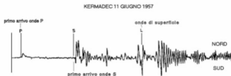
**Figura 5.** Sismogramma tipo registrato in superficie a grande distanza.
