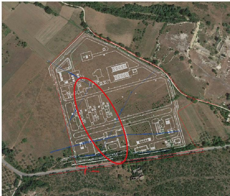
**Figura 3.** Ubicazione del sito in oggetto: la delimitazione ellissoidale in rosso indica l'area in cui è stata eseguita la sezione 2, le linee in blu indicano i sottoservizi. (GoogleEarth).
