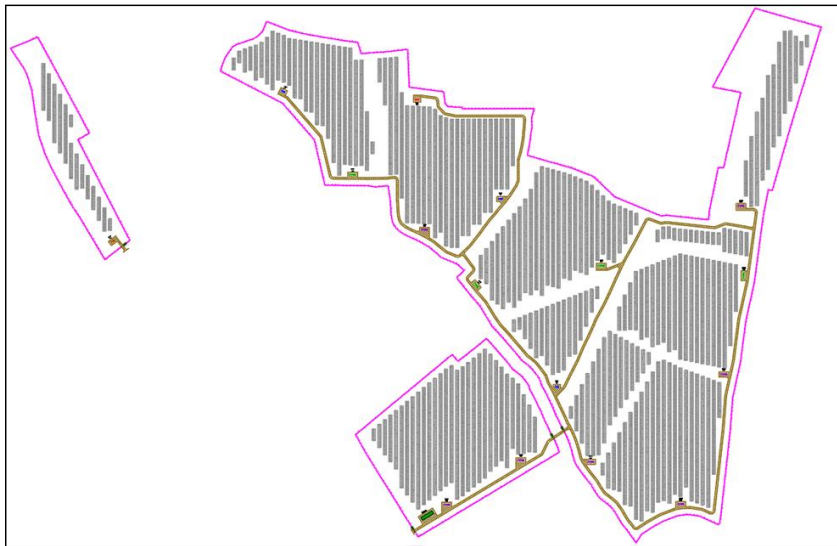
Figura 45: Area di impianto – In magenta le recinzioni aventi altezza pari a 2,65 m.
