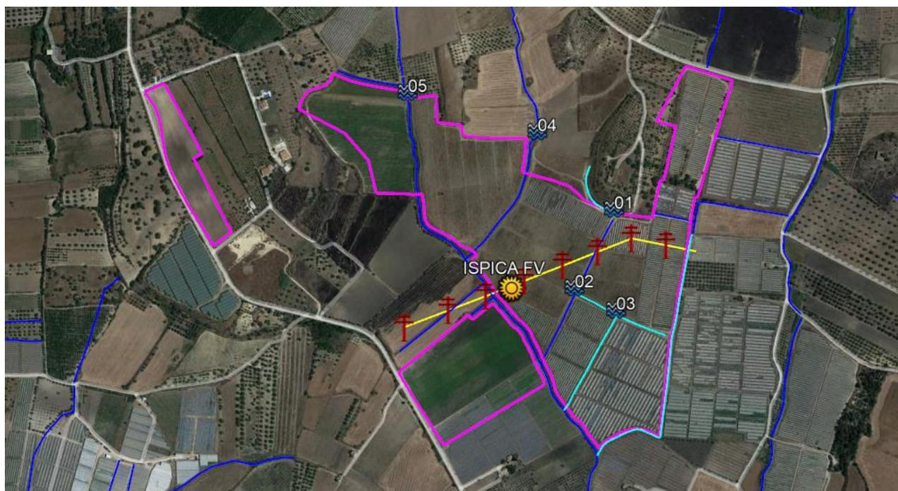
**Figura 9: planimetria impianto, in blu e ciano i canali, in giallo le linee aeree.**
