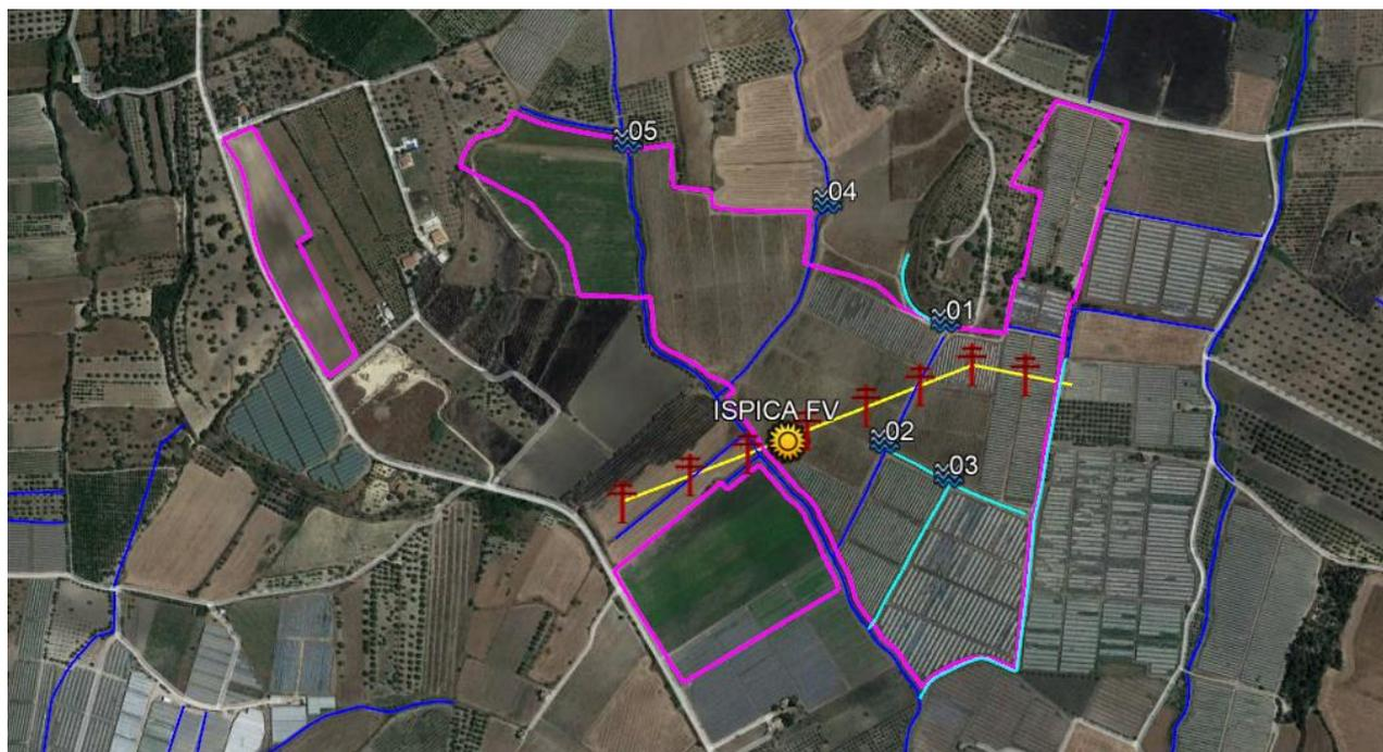
**Figura 7: planimetria impianto, in blu e ciano i canali, in giallo le linee aeree.**
