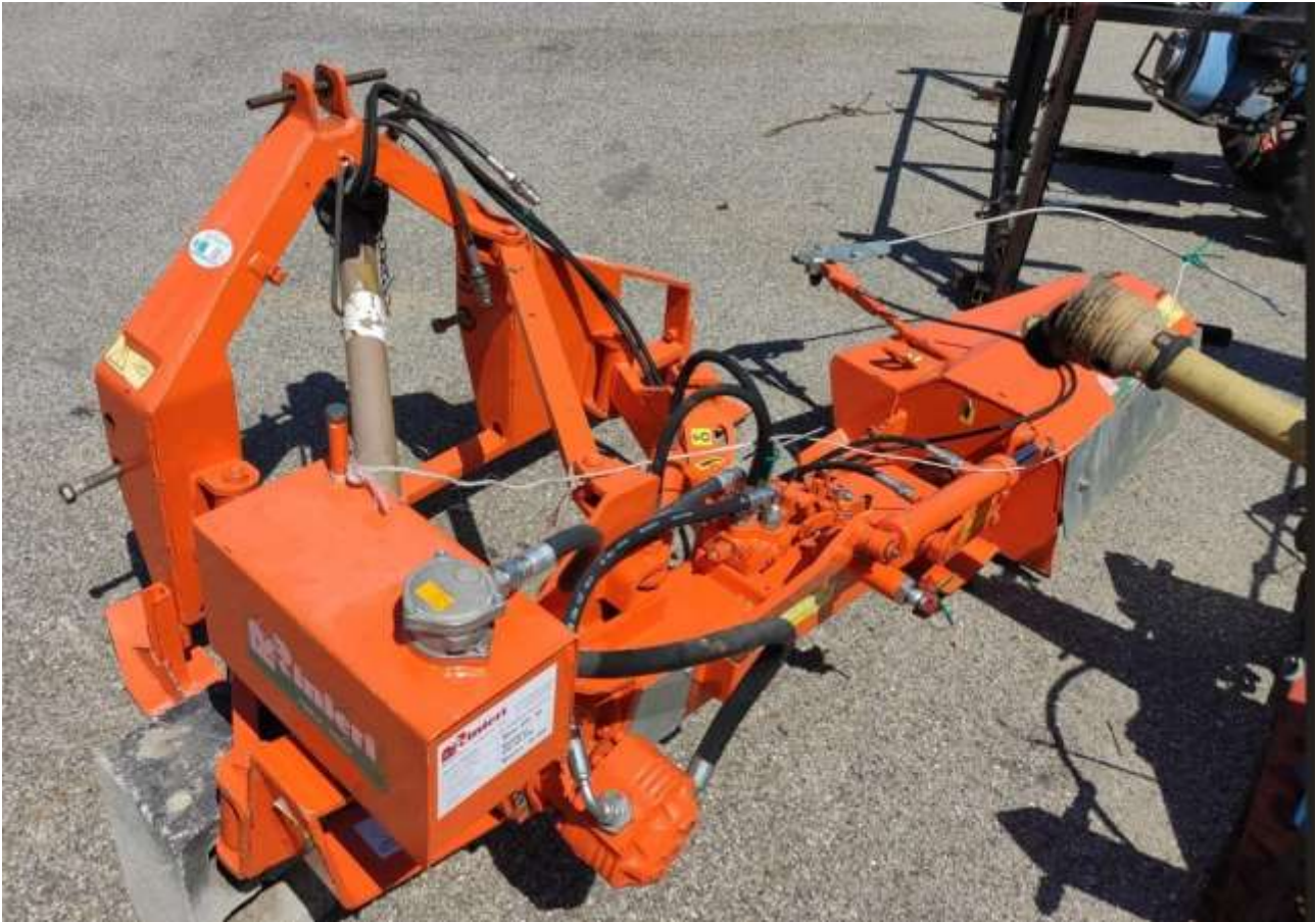
(Fresatrice interceppo. Il dispositivo che fa evitare all'attrezzo di urtare i sostegni delle stringhe)
