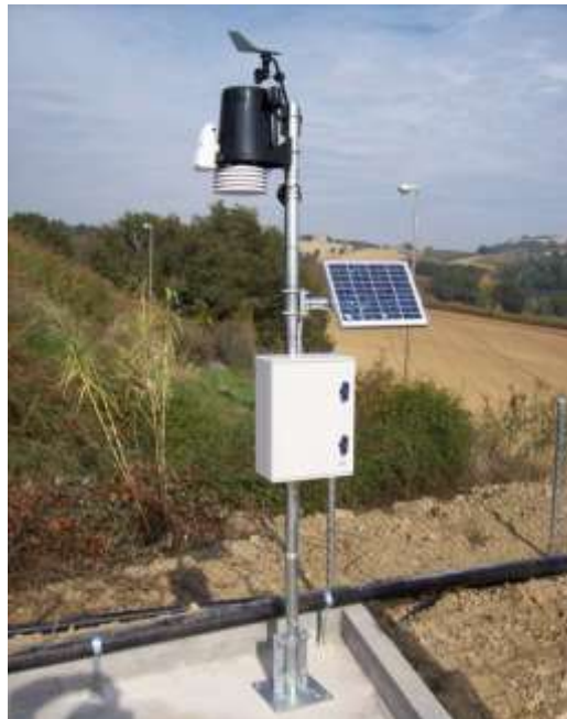
(Esempio di stazione meteorologica per impianto fotovoltaico)
