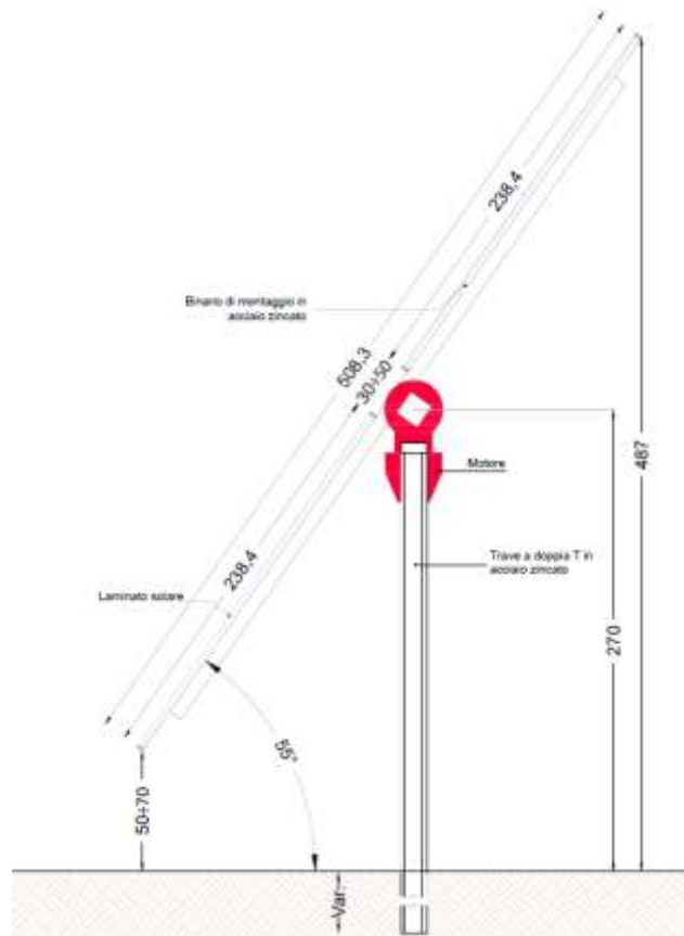
(Sezione tipo di tracker con inclinazione a 55°, misure in cm)
