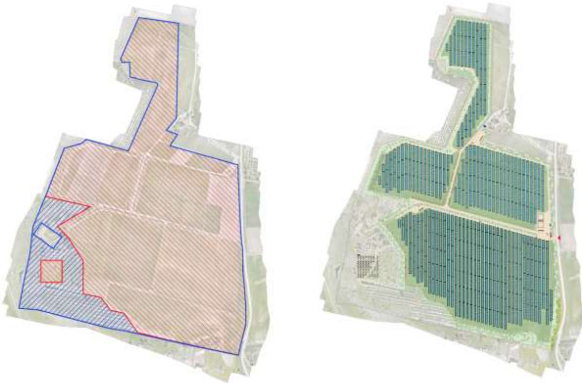
(A sinistra: Area disponibile - perimetro blu - e area dell'impianto agrofotovoltaico -in rosso; A destra il layout generale di impianto)
