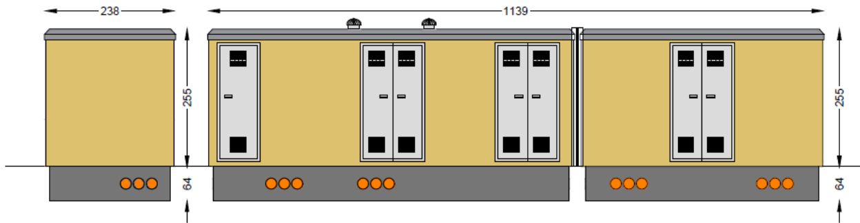
(Prospetto della cabina MTR, misure in cm)
