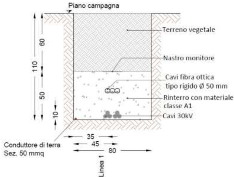
(Sezione tipo di scavo su terreno vegetale)
