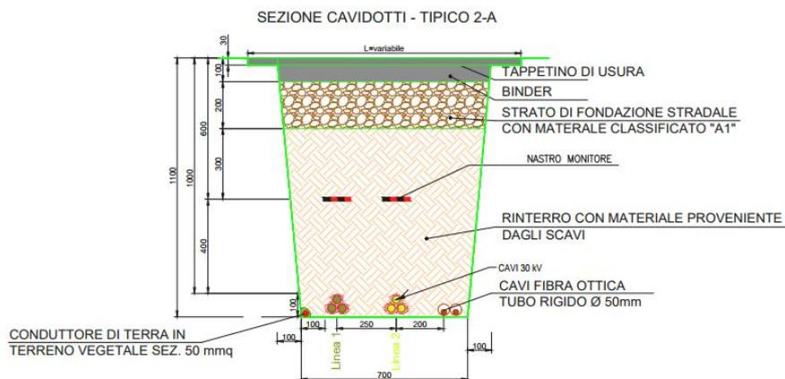
Figura 19- Sezione tipo di scavo – doppia terna MT su strada asfaltata (comunale)
