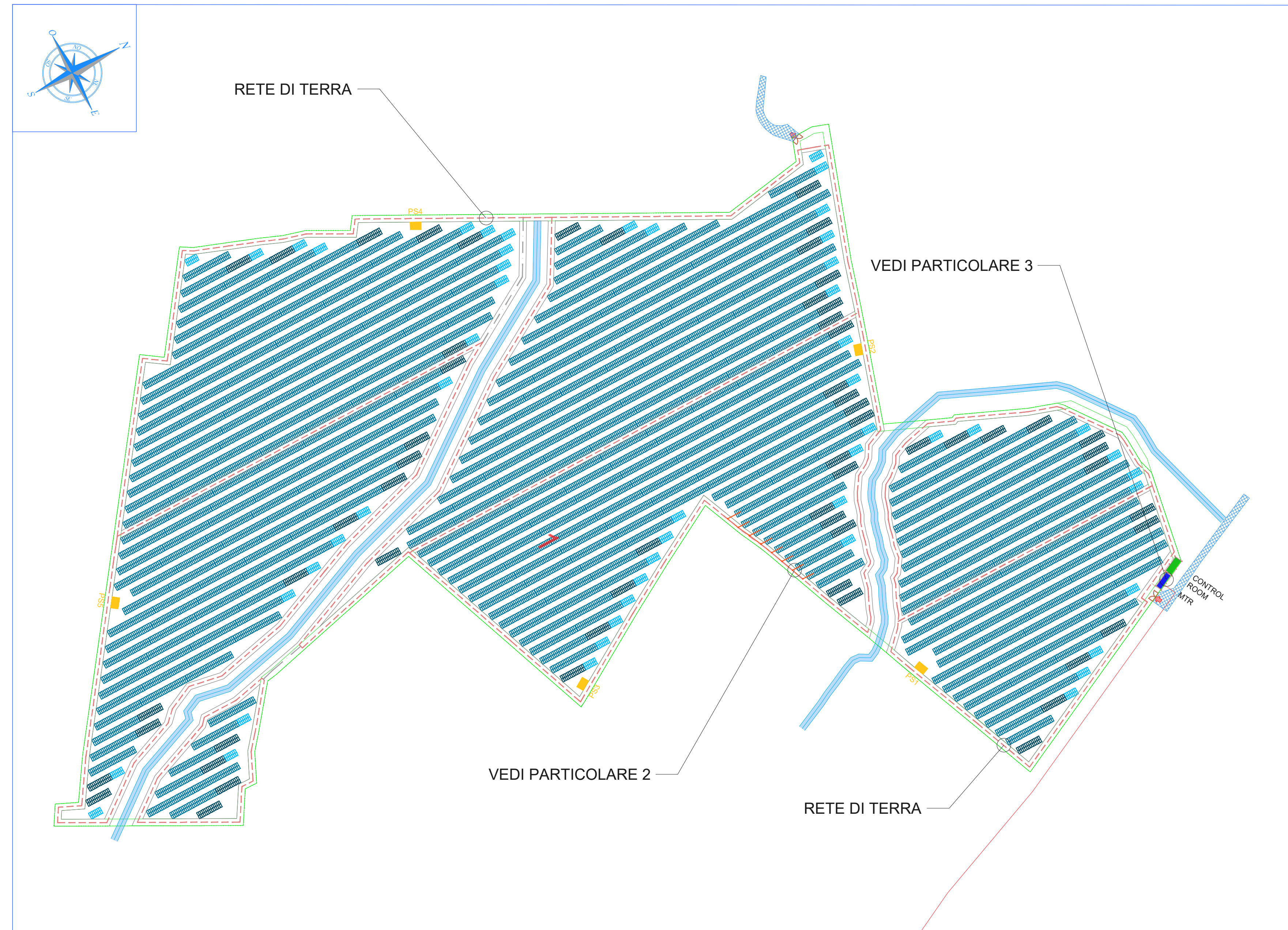
IMPIANTO AGRO-FOTOVOLTAICO FAVARA - RETE DI TERRA Scala 1:2.000
