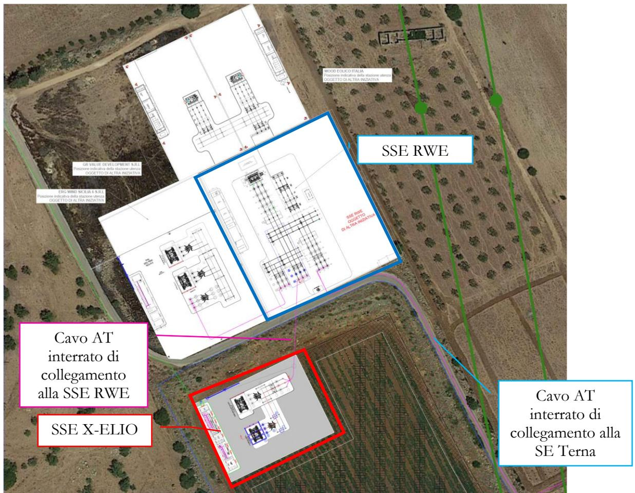
Figura 6 – Planimetria con individuazione nuova SSE ed elettrodotto di collegamento alla SE Terna esistente
