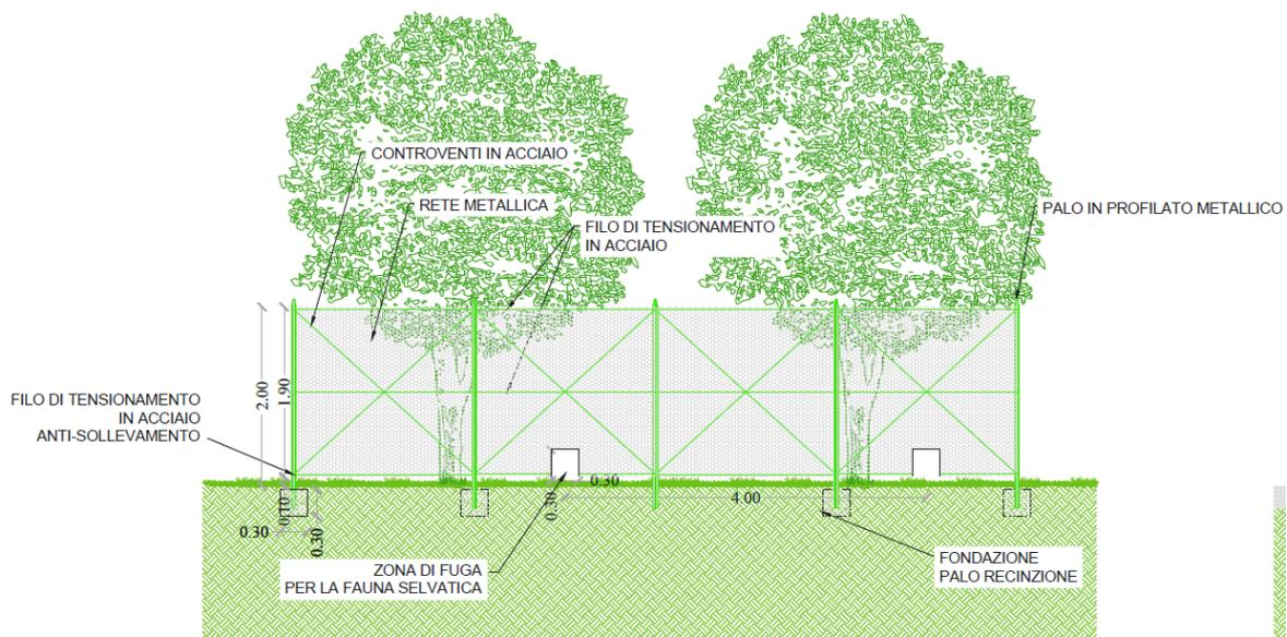
Figura 23 - Particolare della recinzione prevista per le arre di impianto
