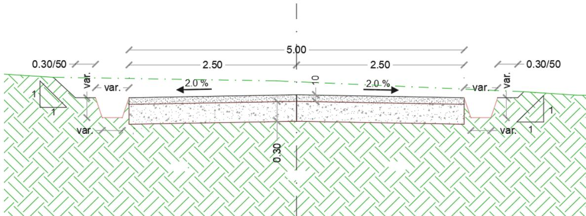
Figura 18 - Sezione tipo della viabilità di servizio
