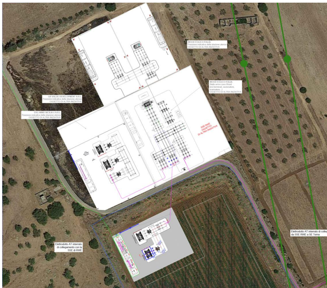
Figura 6 – Planimetria con individuazione nuova SSE e elettrodotti di collegamento alla SE Terna esistente
