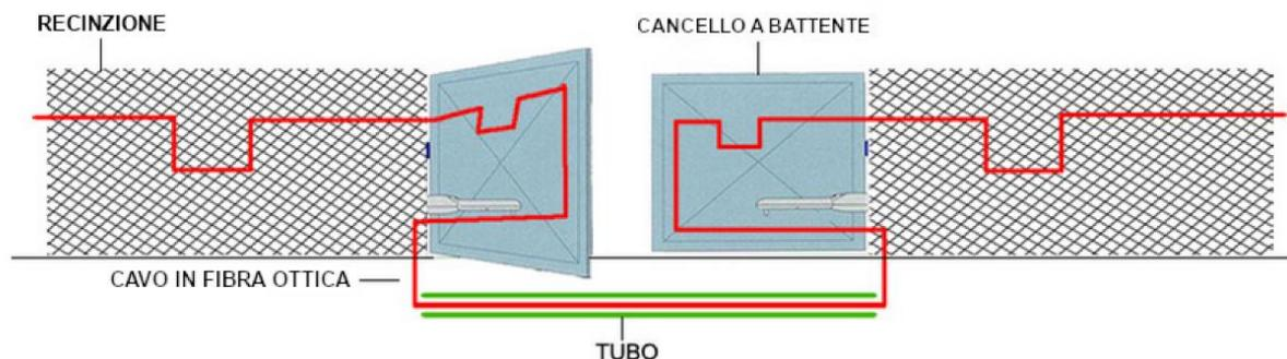
Figura 4.7 - Schema di installazione cavo in fibra ottica su recinzione.
