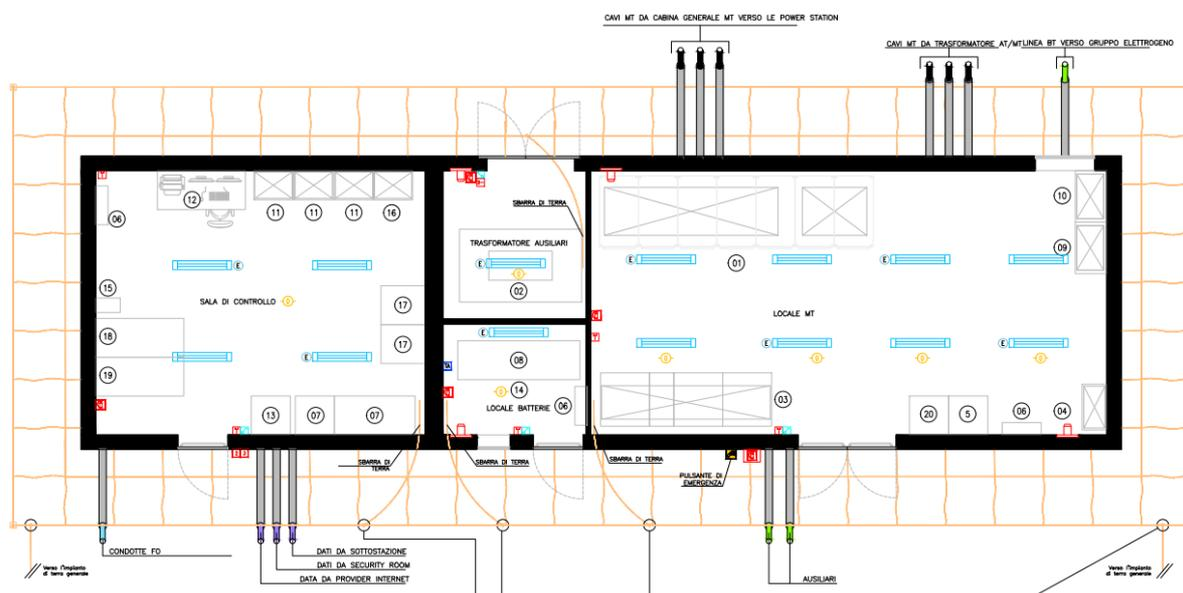
Figura 4.4 - Posizionamento plafoniere nella cabina AT.
