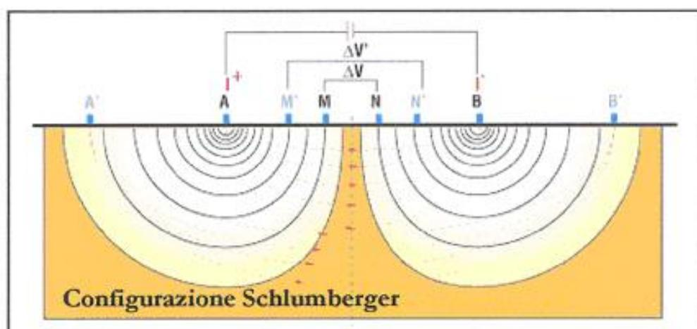
(Fig. 1 - La configurazione Schlumberger)
