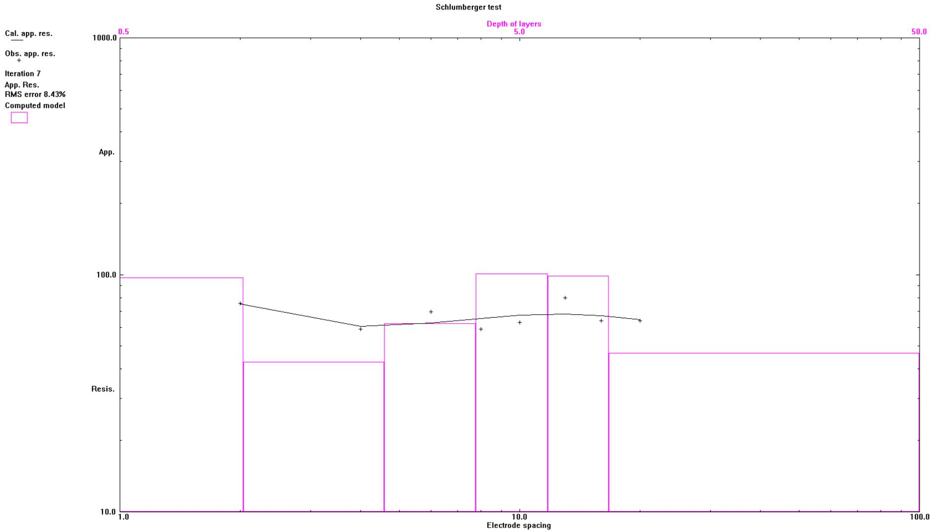
Fig. 2 (Curva di resistività apparente e relativo modello di calcolo-Sev\_1)
