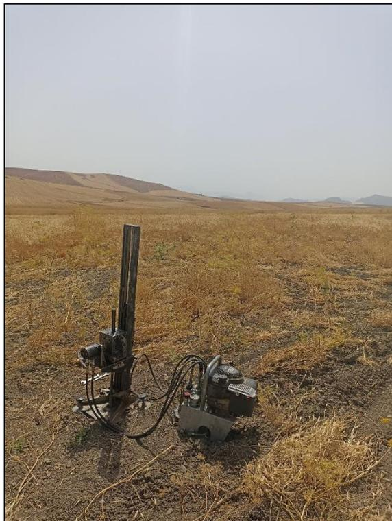
**Fig\_1-Postazione prova penetrometrica Din02**
