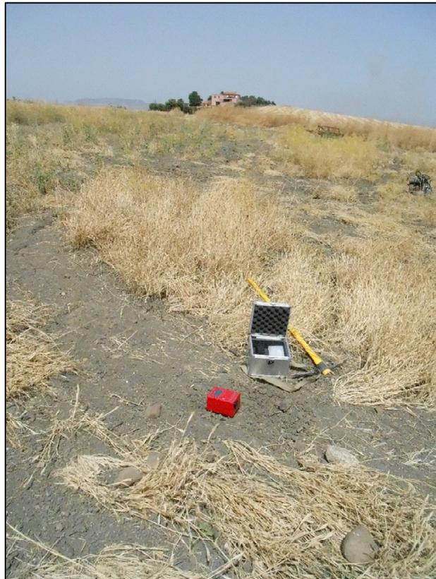
TR1: Acquisizione sismica effettuata nell'area interessata dall'impianto
