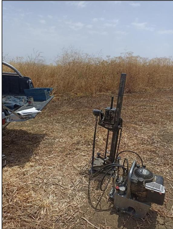
**Fig\_1-Postazione prova penetrometrica Din01**
