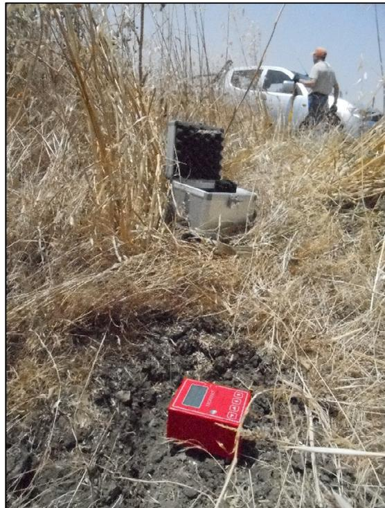
TR3: Acquisizione sismica effettuata nell'area interessata dall'impianto
