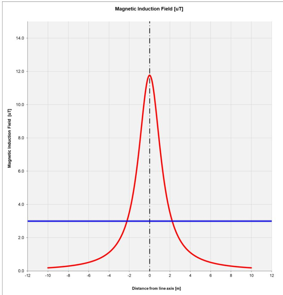
**Figura 2:** *Andamento dell'induzione magnetica prodotta dalla linea in cavo AT calcolata a livello del suolo*
