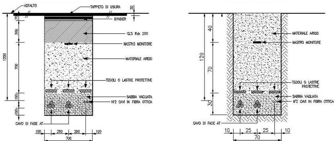
**Figura 1:** *Tipici di posa cavi AT su strade sterrate*
