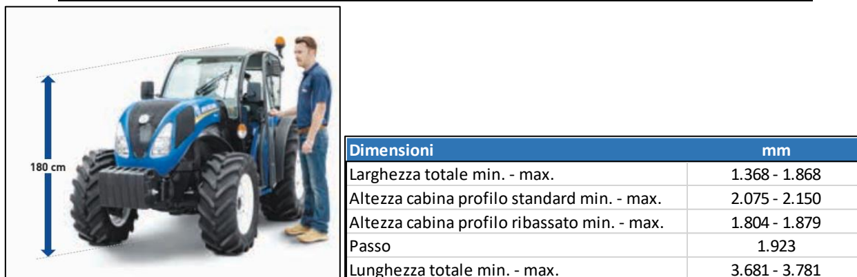
Figura 9.1: Dimensioni caratteristiche di un trattore da frutteto con cabina ribassata (Fonte: CNH)
