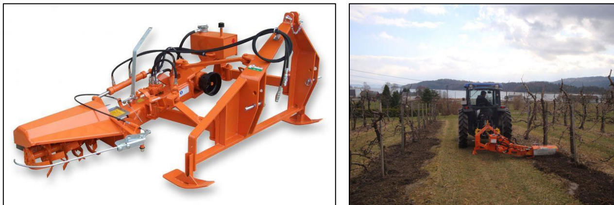
Figura 7.3: Esempio di fresatrice interceppo per le lavorazioni sulla fila (Foto: Rinieri S.r.l.)
