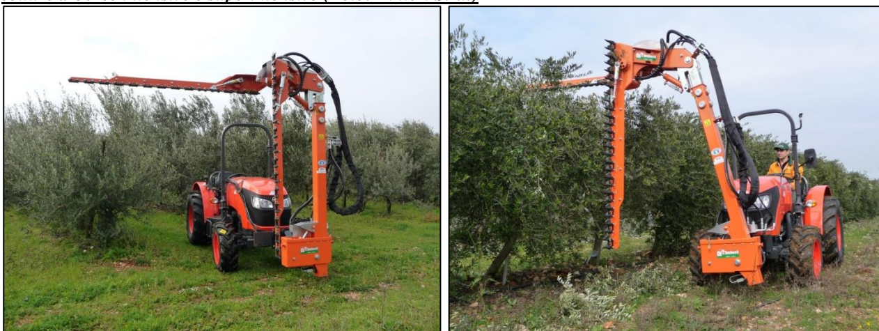
Figura 9.3: Esempio di potatrice meccanica frontale a doppia barra (taglio verticale + topping) utilizzabile su tutti le colture arboree intensive e superintensive (Foto: Rinieri S.r.l.)
