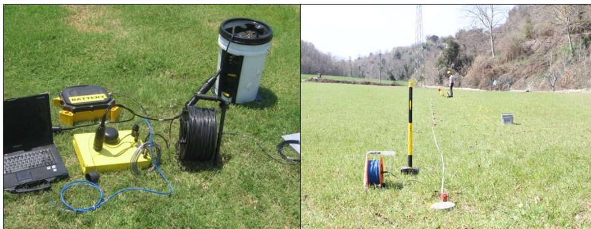
Figura 10.2: A sinistra sismografo DaqLinkIII, a destra le operazioni di acquisizione.
