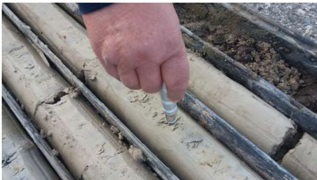
Prove di compressione sulle argille con Pocket Penetrometer
