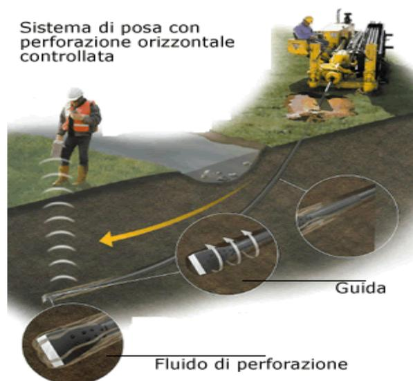
**Figure 9 Sistema di trivellazione orizzontale controllata (T.O.C.).**
