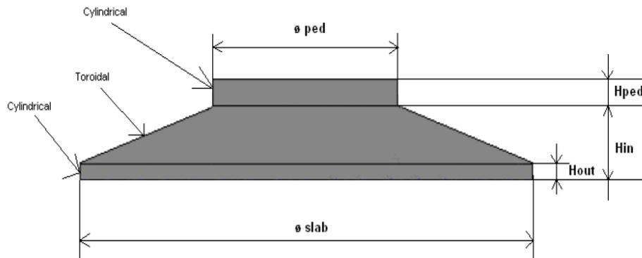
**Figura -3: Sezione tipo del plinto fondazione**
