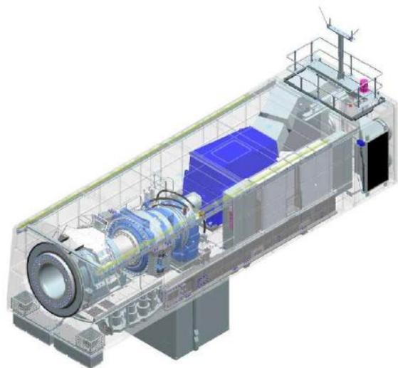
**Figura** Errore. Nel documento non esiste testo dello stile specificato. **-2: Tipico navicella WTG**
