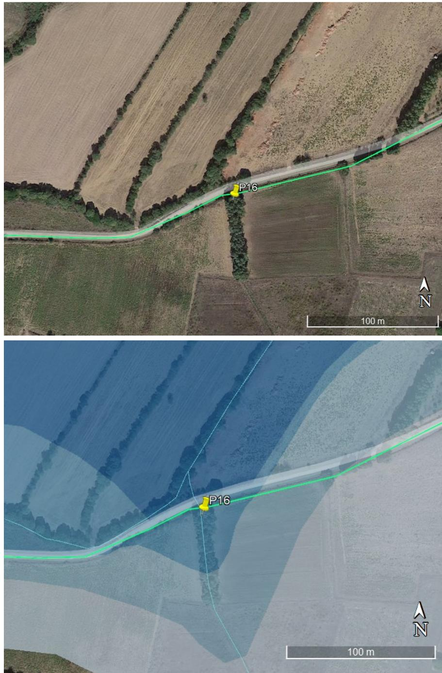
Figura 7.26: Ubicazione interferenza P16, in verde il tracciato della linea di connessione, in celeste il reticolo secondo Strahler (ordine 1) e stralcio PSFF (pericolosità media).
