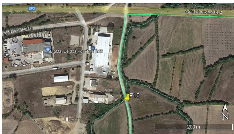
Figura 7.17: Ubicazione interferenza P10, in verde il tracciato della linea di connessione, in celeste il reticolo secondo Strahler (ordine 2).
