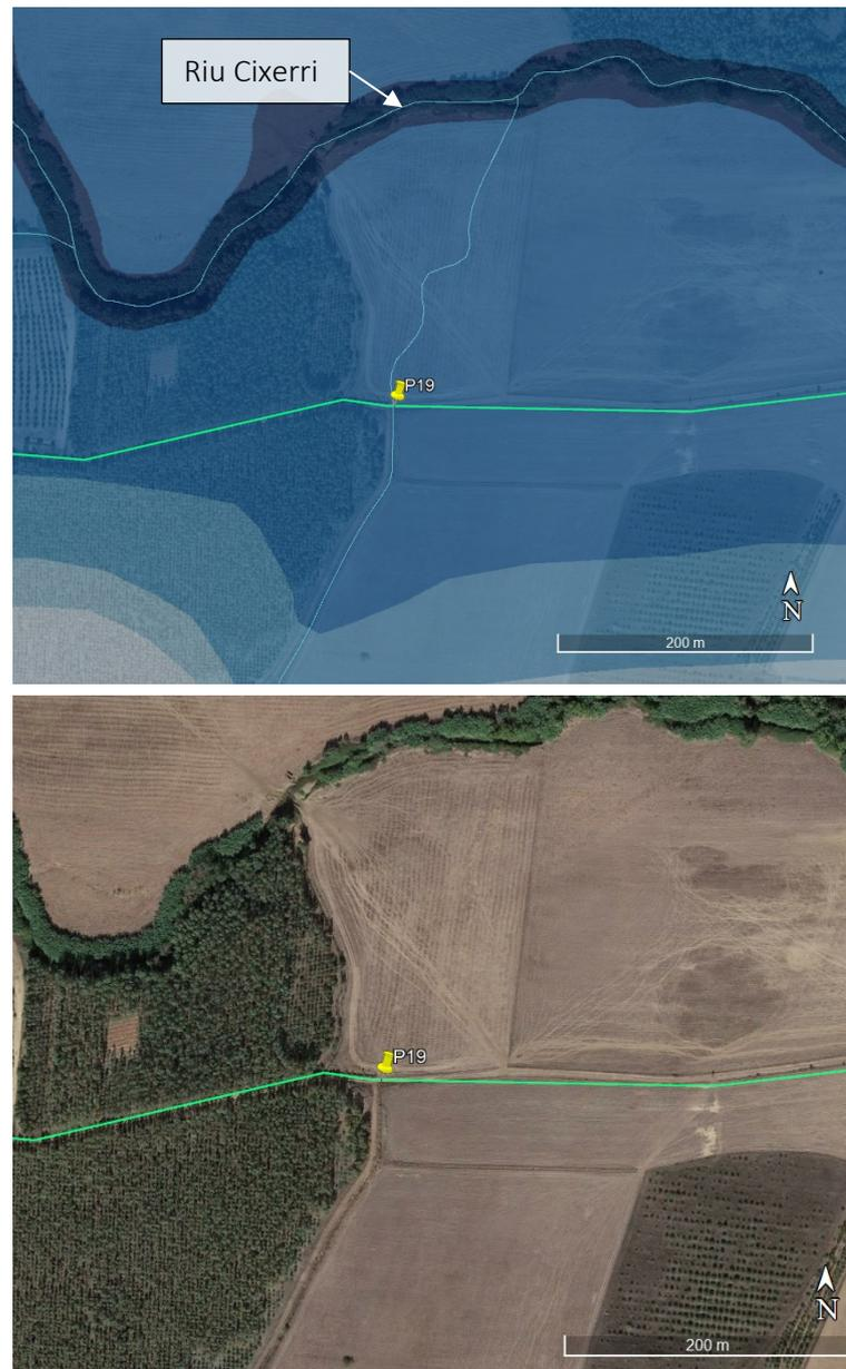
Figura 7.31: Ubicazione interferenza P19, in verde il tracciato della linea di connessione, in celeste il reticolo secondo Strahler (ordine 3), fascia di pericolosità alta.
