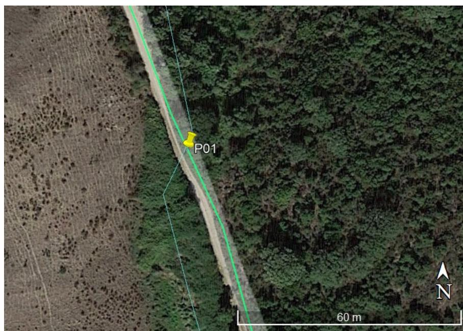
Figura 7.5: Ubicazione interferenza P01, in verde il tracciato della linea di connessione, in celeste il reticolo secondo Strahler (ordine 2).
