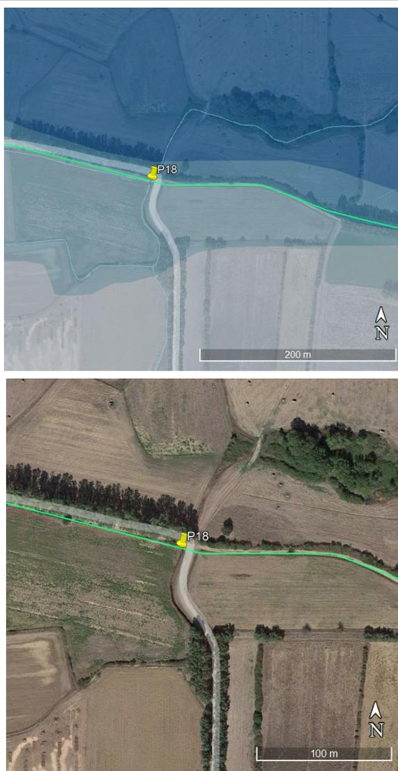
Figura 7.30: Ubicazione interferenza P18, in verde il tracciato della linea di connessione, in celeste il reticolo secondo Strahler (ordine 2) e stralcio PSFF 2015.
