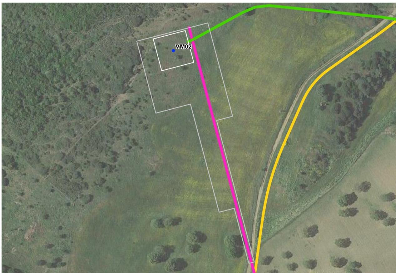
Figura 6.5: Dettaglio della localizzazione della WTG e della relativa piazzola e area di cantiere su ortofoto.
