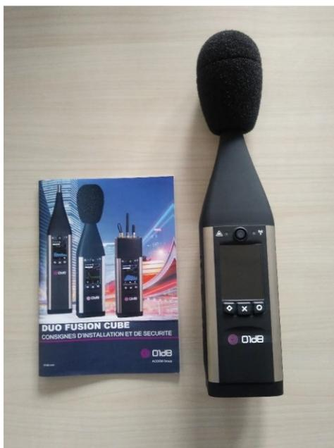
Figura 3.6: Fonometro 01dB Fusion
