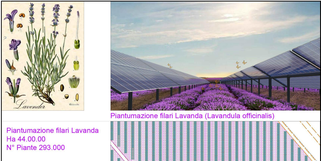
Figura 13: Coltivazione lavanda interfile pannelli fotovoltaici
