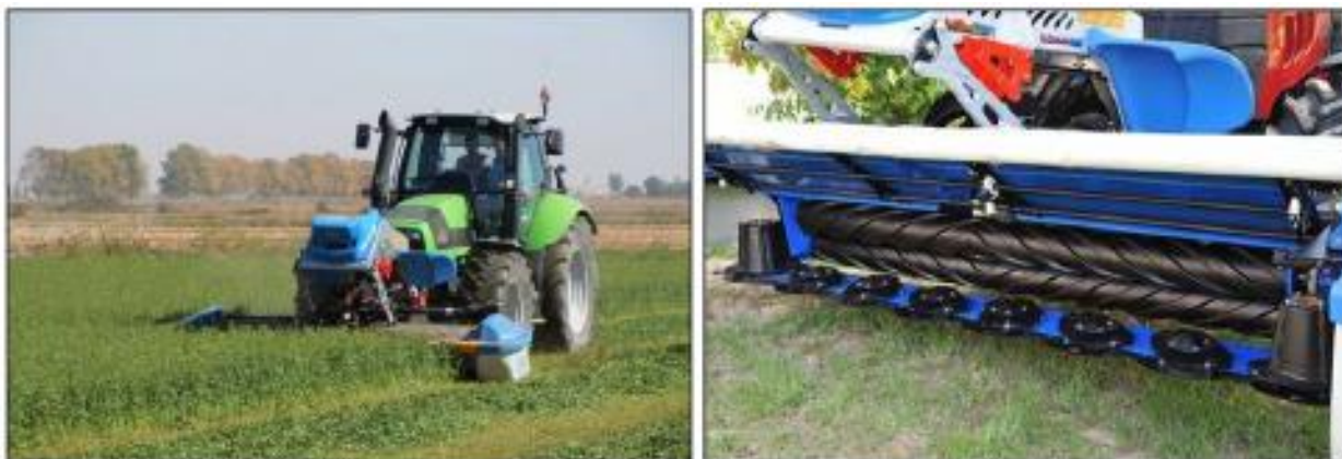
Figura 10: Esempio di falciacondizionatrice frontale e particolare dei rulli in gomma
