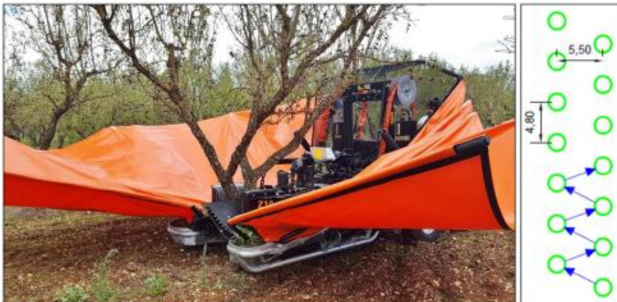
Figura 20: Macchina frontale per la raccolta delle mandorle su impianto intensivo e disposizione ideale degli alberi per il corretto impiego della stessa
