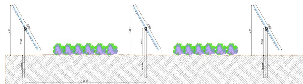
DETTAGLIO SEZIONE LONGITUDINALE STRUTTURA - SCALA 1:100
