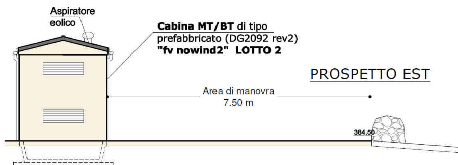
Figura 4: Prospetto laterale della cabina MT/BT
