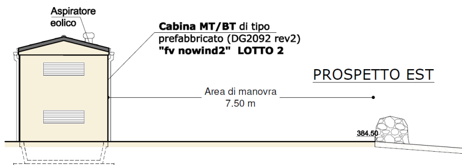
Figura 9: Prospetto laterale della cabina MT/BT
