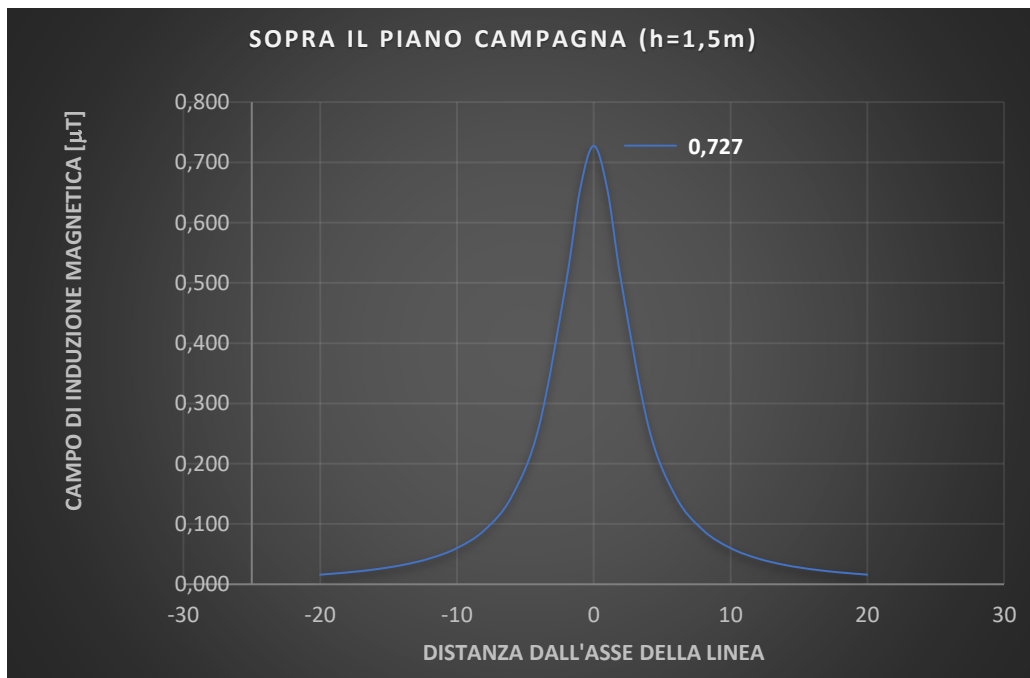
Figura 40: campo elettromagnetico a 1,5 m sopra il suolo
